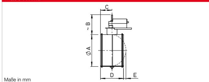
**Motorbetätigte Rohrverschlussklappe dicht**
