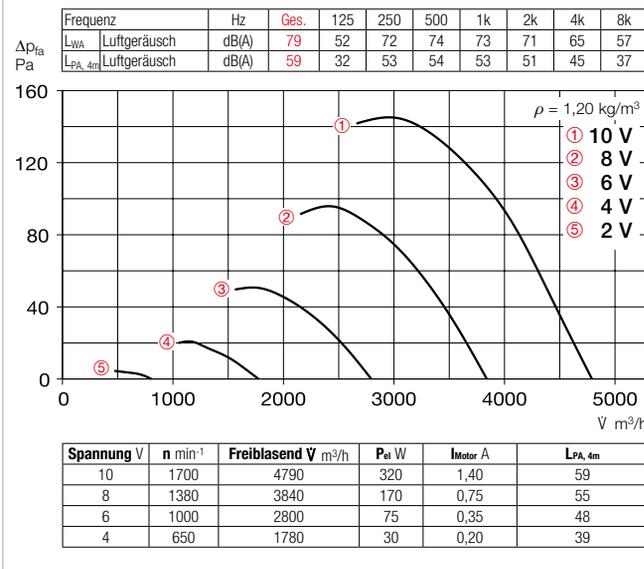
**Kennlinien HQ EC / HW EC / HRF EC 400 B**
