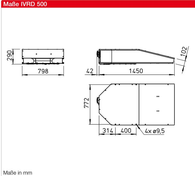
Hochwertige, leistungsstarke Impulsventilatoren mit optimalen Abmessungen für geringsten Platzbedarf. Geeignet zur Be- und Entlüftung von Parkgaragen mit Fördermitteltemperaturen von bis zu 60 °C.
