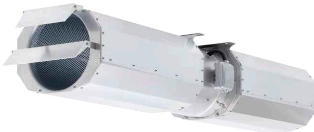
**Hochwertige, leistungsstarke Impulsventilatoren mit optimalen Abmessungen für geringsten Platzbedarf. Geeignet zur Be- und Entlüftung bzw. zur Entrauchung von Garagen. Temperaturbereich wahlweise 300 °C/120 Min. oder 400 °C/120 Min. (im Entrauchungsbetrieb) bzw. 60 °C bei Dauerbetrieb.**
