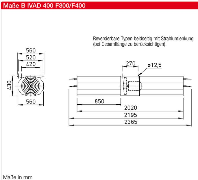
**Hochwertige, leistungsstarke Impulsventilatoren mit optimalen Abmessungen für geringsten Platzbedarf. Geeignet zur Be- und Entlüftung bzw. zur Entrauchung von Garagen. Temperaturbereich wahlweise 300 °C/120 Min. oder 400 °C/120 Min. (im Entrauchungsbetrieb) bzw. 60 °C bei Dauerbetrieb.**
