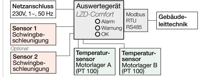
Die Helios Lager-Zustandsdiagnostik ist ein System zur Sicherstellung der Funktionsfähigkeit von Motorlagern auch nach längerem Stillstand, wie es bei Helios Brandgasventilatoren der Fall sein kann. Das System überprüft den Zustand der Motorlager und wertet diesen aus. Die Ergebnisausgabe erfolgt direkt im Ampelprinzip zur schnellen Erfassung vor Ort oder durch die optionale Einbindung in die Gebäudeleittechnik.
