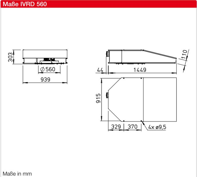
Hochwertige, leistungsstarke Impulsventilatoren mit optimalen Abmessungen für geringsten Platzbedarf. Geeignet zur Be- und Entlüftung von Garagen mit Fördermitteltemperaturen von bis zu 60 °C.
