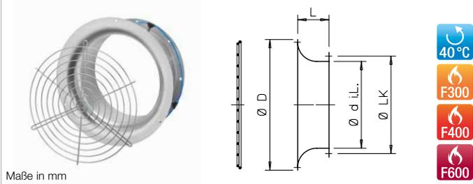
**Ansaugdüse mit Schutzgitter** und großem Einlauffradius. Aus Stahlblech gedrückt, feuerverzinkt. Anschlussseitig mit Flansch nach DIN 24155, Bl. 2. Schutzgitter zur saugseitigen Abdeckung, DIN EN ISO 13857 entsprechend.
