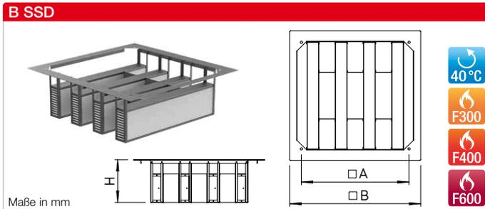
**Schalldämpfereinsatz für Flachdachsockel B SSD**
