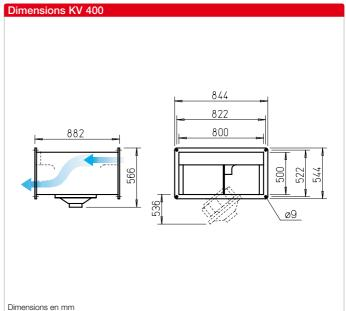
Ventilateurs centrifuges avec turbine à action. Groupe moto-turbine pivotable pour montage en gaines rectangulaires.
