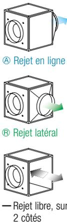
Position de montage et installation au choix grâce aux cinq directions de rejet possibles.
