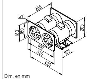
**Un faible encombrement pour un débit et une pression élevés.** Conçus pour être insérés directement sur les réseaux de gaines. Nombreuses applications dans les domaines tertiaires, industriels et résidentiels.
