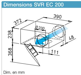
**Ventilateurs centrifuges EC à faible consommation d'énergie destinés au transfert de faibles et moyens volumes d'air avec une pression élevée.**
