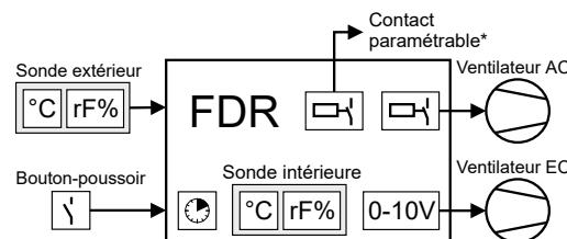
\* Chauffage d'appoint, déshumidificateur supplémentaire, fonction d'air pulsé ou message d'erreur
