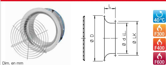
**Pavillon d'aspiration avec grille** avec un grand rayon d'entrée. Fabriqué en tôle d'acier emboutie, galvanisée à chaud. Côté raccordement avec bride conforme à DIN 24155, partie 2. Grille de protection côté aspiration, conforme à la norme DIN EN ISO 13857. Version
