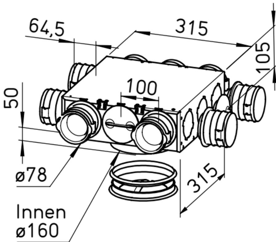
Kernloch- $\varnothing \geq 172$  mm
