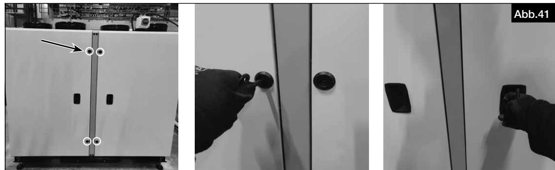
2. Verriegelung ziehen, um die Filter zu lösen (Abb.42). Filter entnehmen.
