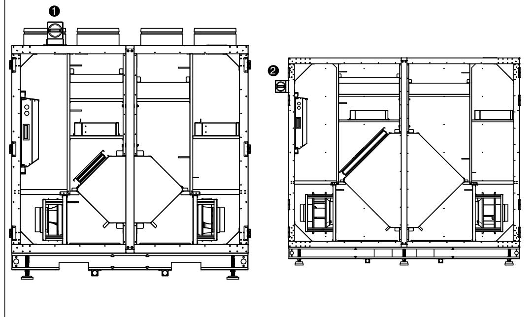
Der Hauptschalter muss bei den AIR1 XVP Geräten wie folgt befestigt werden:
