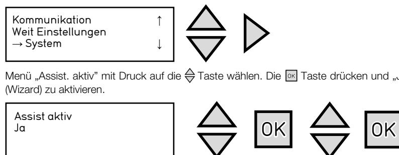
Die Steuerung führt einen Neustart durch, um den Inbetriebnahme-Assistenten (Wizard) zu aktivieren. Das Gerät kann nicht betrieben werden, wenn der Inbetriebnahme-Assistent (Wizard) aktiv ist.
