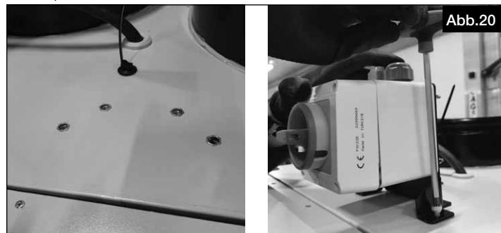
3. Das Hauptschaltergehäuse öffnen (s. Abb.21). Leitungsquerschnitt, der für den Stromanschluss verwendet wird, überprüfen.
