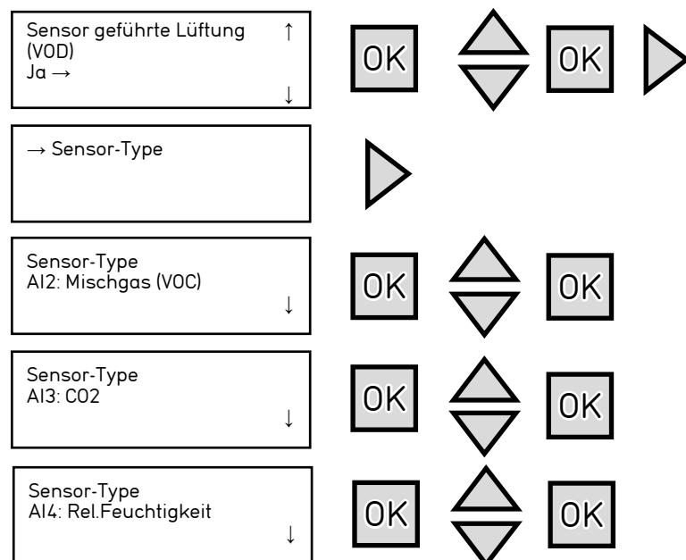
**OK**Taste drücken, um „JA“ in dem Menü „sensorgeführter Betrieb“ auszuwählen. Die  $\triangleleft$  Taste drücken, um „JA“ auszuwählen und die  $\triangleright$  Taste drücken, um die angeschlossenen Sensortypen (AI2, AI3, AI4) auszuwählen. Nach Auswahl der Sensortypen auf die  $\triangleleft$  Taste drücken, um zu den Sensor-Einstellungen zu gelangen.
