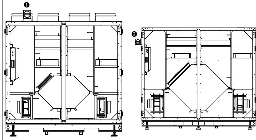
Pour les centrales AIR1 XVP..., l'interrupteur principal doit être fixé comme suit :
