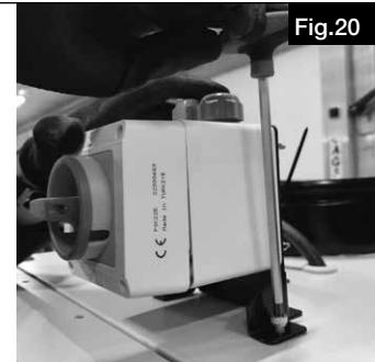
3. Ouvrir le boîtier de l'interrupteur principal (voir Fig.21). Vérifier la section du câble utilisé pour le raccordement électrique.
