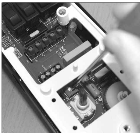
Abb. 2d: Justierpotentiometer zur Einstellung der Mindestdrehzahl
