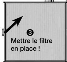
Fig. 16 Pour le raccordement d'une 2e pièce : Mettre en place le filtre ④ du kit de la deuxième pièce ELS-ZS !
