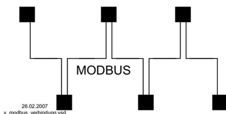
L'alignement des données doit être guidé d'un appareil à l'autre. Un autre type de câblage n'est pas autorisé ! Seuls deux conducteurs d'un câble (paire torsadée) peuvent être utilisés pour la liaison des données.
