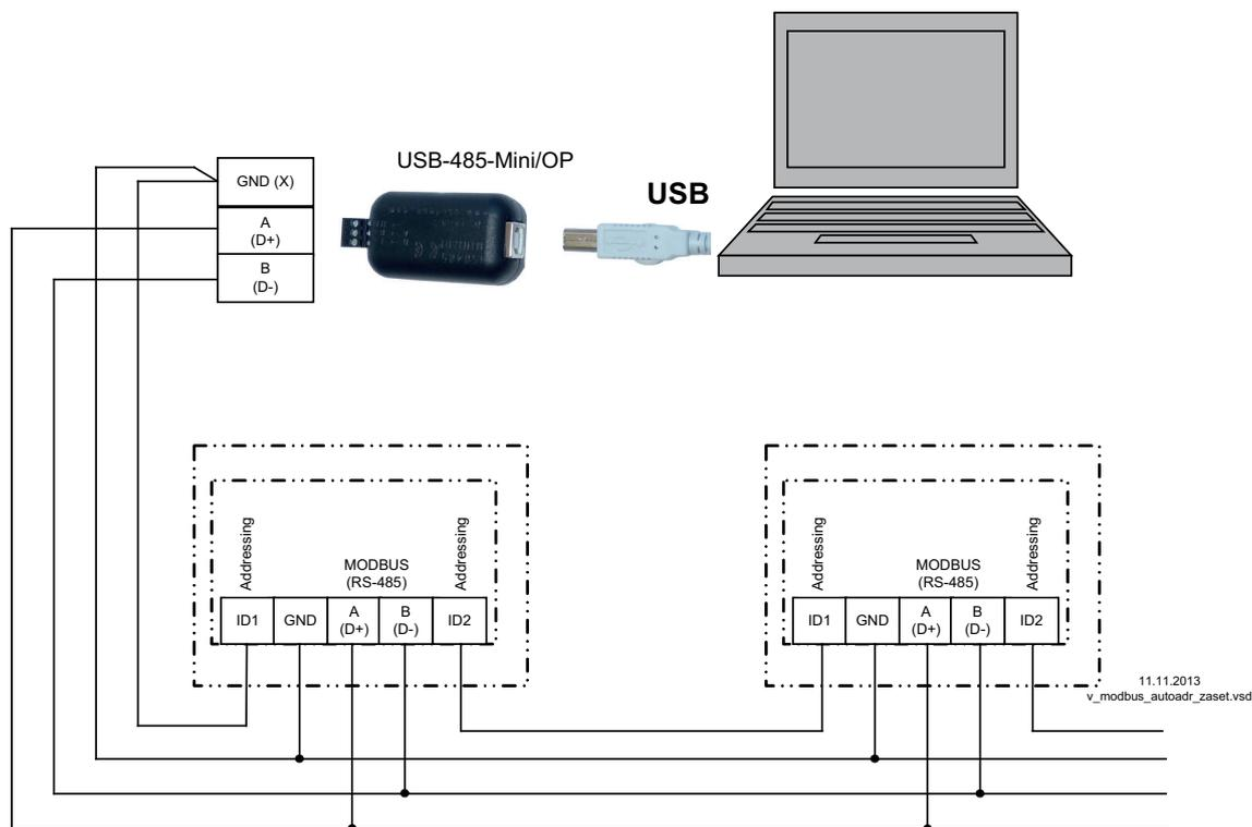
Au raccordement USB-485 du convertisseur aux bornes : A (D+), B (D-) et GND.
