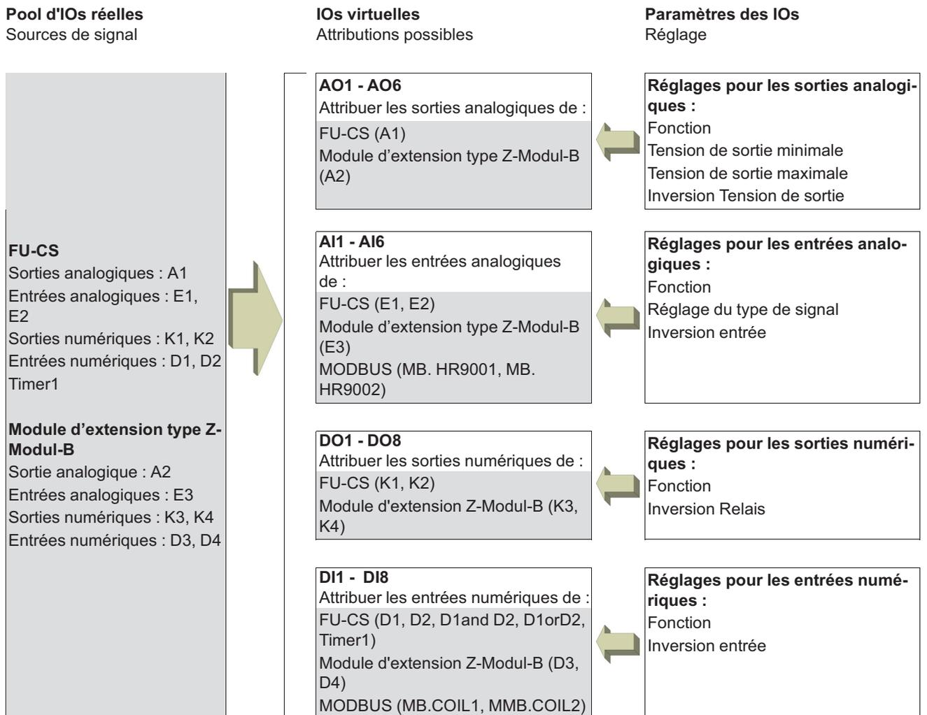
Exemple : attribution d'entrées pour des capteurs de température
