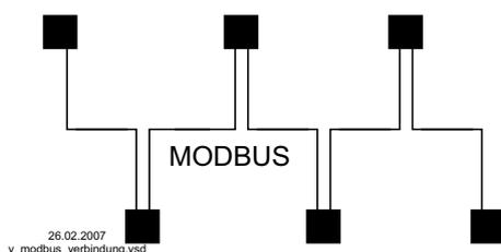
Die Datenleitung muss von einem Gerät zum nächsten geführt werden. Eine andere Verdrahtungsart ist nicht zulässig!
