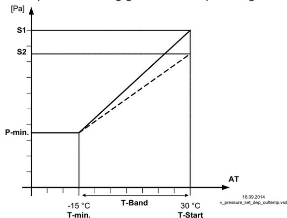
Bei Betrieb als Druckregelgerät kann eine Außentemperaturkompensation aktiviert werden (Sensoranschluss an "E2"= "Analog In 2"). Der eingestellte und aktive "Sollwert 1" bzw "Sollwert 2" wird durch diese Funktion automatisch proportional zur gemessenen Außentemperatur verändert (Info: "Sollwert Regelung").
