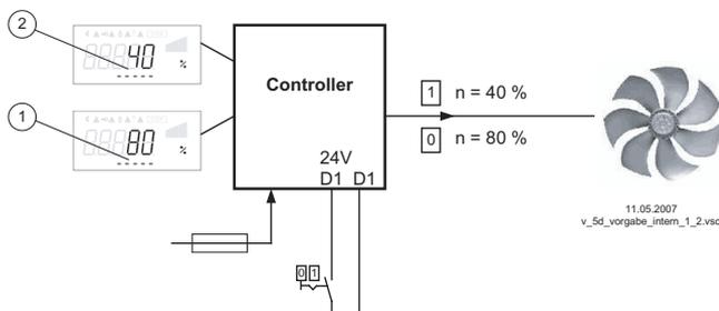
1 Réglage "Vitesse Interne1" (selon le type d'appareil en : %, Hz, tr/min.)
