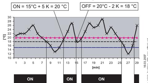
Die Kühlung bleibt bei einer Raumtemperatur über dem eingestellten Einschaltpunkt eingeschaltet. Unterschreitet die Raumtemperatur den eingestellten Einschaltpunkt der Kühlung um 2,0 K (Kelvin), wird diese ausgeschaltet. D. h. der Ausschaltpunkt liegt um den Hysteresewert unter dem Einschaltpunkt.
