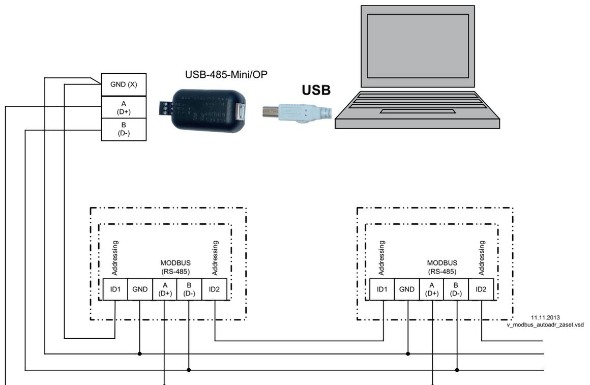
Am USB-485 Konverter Anschluss an den Klemmen: A (D+), B (D-) und GND.
