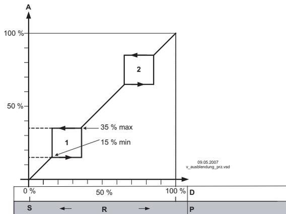
Réglage selon le type d'appareil en : %, Hz, tr/min
