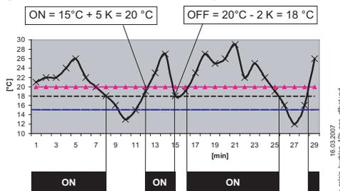
Le refroidissement reste en marche lorsque la température ambiante est supérieure au point d'enclenchement réglé. Si la température ambiante passe en dessous du point d'enclenchement réglé du refroidissement de 2,0 K (Kelvin), celui-ci est arrêté, c'est-à-dire que le point de coupure est inférieur au point d'enclenchement de la valeur de l'hystérésis.
