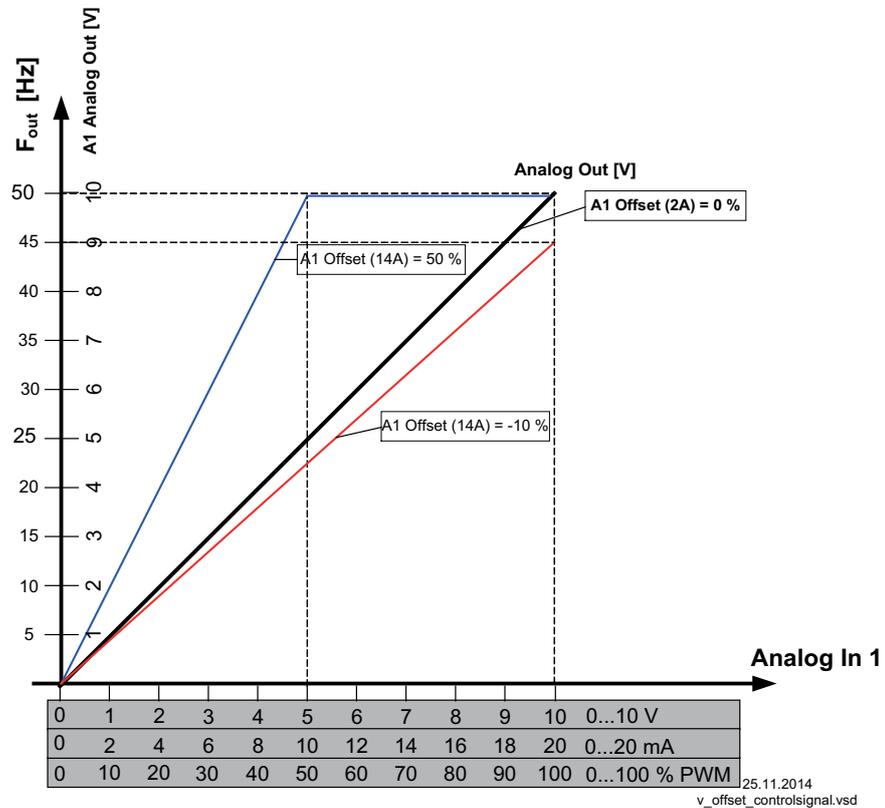
**9.8.12 Auswahlverstärker (Komparator) Regelkreis 1 oder 2 auf Ausgang U, V, W**
