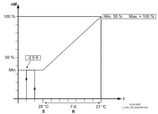
Arrêt minimum (schéma de principe idéalisé)
