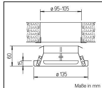
montage (ex.: montage en hauteur), les bouches doivent être fixées dans le conduit par un adhésif double-face aux ressorts.
