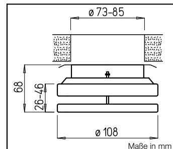
les bouches doivent être fixées dans le conduit par un adhésif double-face aux ressorts.
