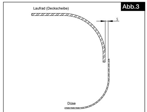
**Entsprechen die festgestellten Werte nicht den Sollmaßen, darf der Ventilator nicht eingebaut bzw. betrieben werden.** Bei Fragen bitte direkt den Helios Kundendienst kontaktieren. **Eigene Reparaturversuche sind strikt untersagt!**
