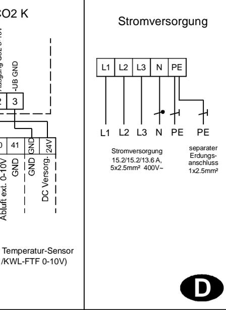
36-37: Luftqualitätssensor 1 oder Temperatur-Sensor (Temperaturausgang AIR1/KWL-FTF 0-10V)
